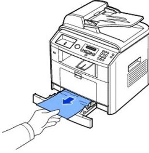
*Se non si riesce a vedere la carta oppure se questa non si muove quando la si tira, controllare l'area del fusore. Per ulteriori informazioni, vedere ["Inceppamento nell'area del fusore"](#).*
