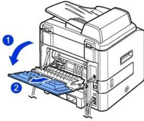
**⚠ ATTENZIONE:** l'area dell'unità fusore all'interno del coperchio posteriore della stampante diventa molto calda durante l'uso. Prestare attenzione quando si accede a quest'area.
